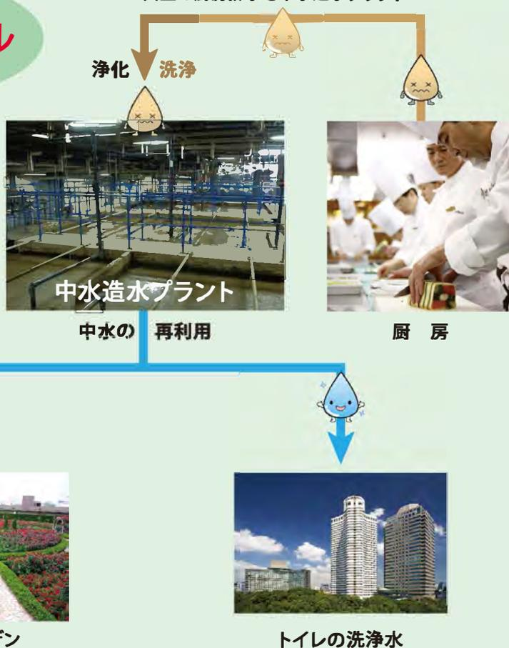
中水造水プラントでリサイクルされた水は、屋上緑化をはじめとする植物への散水、トイレの洗浄水、洗車用の水などに再利用されています。
